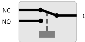
Interner Betrieb des programmierbaren Relais
