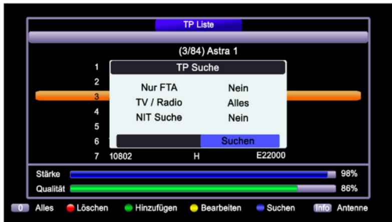
Nach allen Suchvorgängen werden die Programme ans Ende der Kanalliste hinzugefügt. Daher empfehlen wir, nach der Suche die Funktion „Kanäle bearbeiten“ zu verwenden.
