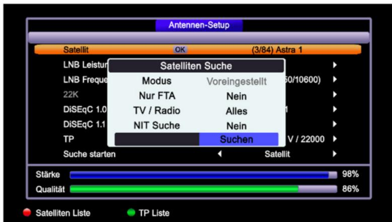
**Nur FTA** bedeutet, dass nur freie, nicht verschlüsselte Kanäle gesucht werden. **TV/Radio** – Suche nach TV- und/oder Radiokanälen. **NIT** – Netzwerksuche.
