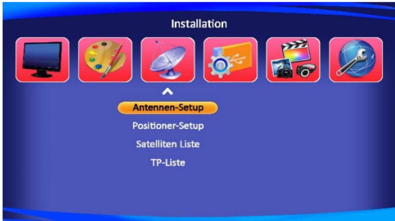
Drücken Sie die Menütaste auf der Fernbedienung, um in das Installationsmenü des Receivers zu gelangen. Mit den Pfeiltasten können Sie zwischen den Hauptkategorien des Menüs sowie den Unterkategorien wählen. Mit der OK-Taste gelangen Sie in den ausgewählten Menüpunkt.
