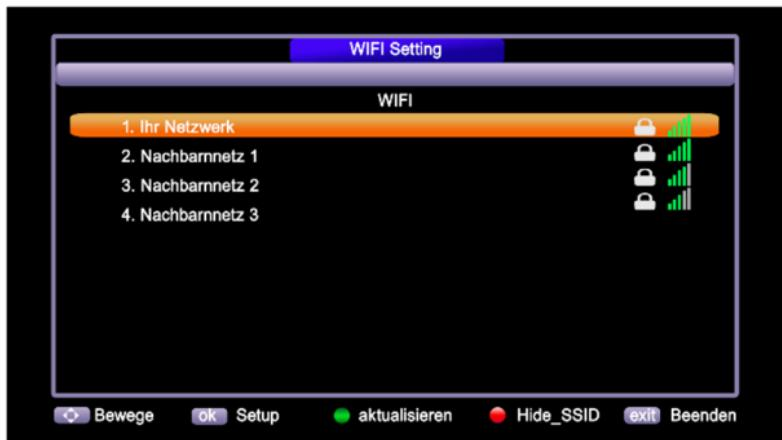
Wählen Sie Ihr Netzwerk aus, gehen Sie mit der Pfeile-Taste zum Passwort-Eingabefeld und drücken Sie "OK". Auf dem Bildschirm erscheint eine Tastatur, in die Sie Ihren WLAN-Netzwerkschlüssel eingeben müssen. Bei korrekten Angaben wird der Receiver mit dem Internet verbunden.
