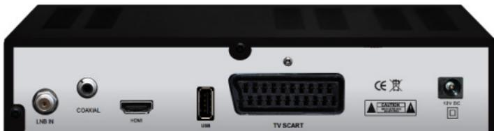
LNB IN Sat LNB Antenneneingang
