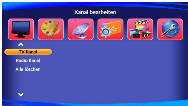
Für die Sortierung der TV-Kanäle wählen Sie „TV Kanal“, für die Sortierung der Radiosender „Radio“. Sie können in diesem Menü auch alle Kanäle löschen.
