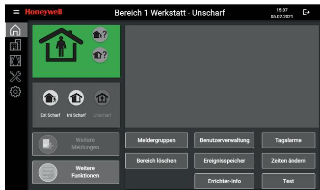
Die Bereichsansicht dient der Bedienung des ausgewählten Bereiches der Zentrale. Diese Ansicht erlaubt den schnellen Überblick über den Status des Bereichs der Zentrale. Meldungen sind farbig hinterlegt und mittels Klartextanzeige ersichtlich.
