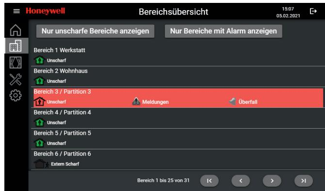
Die Bereichsübersicht erlaubt den schnellen Überblick über den Status der einzelnen Bereiche der Zentrale. Meldungen sind farbig hinterlegt und mittels Klartextanzeige ersichtlich.
