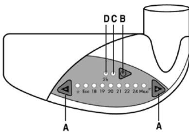
Nach dem Anschließen des Heizkörpers an die Energieversorgung schalten Sie ihn ein, indem Sie auf die Taste **B** drücken. **[B]** Die Heizungsleuchte **[C]** leuchtet auf.
