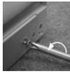
3. Abdeckleiste ( 3 Schrauben) abschrauben.
