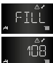
Durch Auffüllen des Heiz-Wassers kann der Kessel wieder Freigegeben werden, siehe Hinweis 1. Wenn die Nachfüllanforderung häufig auftritt, schalten Sie den Heizkessel aus, stellen Sie den externen elektrischen Schalter auf OFF, schließen Sie den Gashahn und wenden Sie sich an Ihren Kundendienst, um eventuelle Wasserlecks zu überprüfen.
